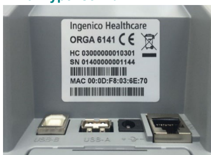
Abbildung 8: Beispiel - Typenschild mit zulässigem Herstellcode HC 0300000010301 oder HC 0300000020301 für V3.9.0:1.2.0
