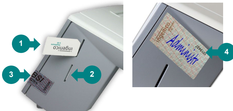
Abbildung 13: Die Kontaktiereinheiten 3 und 4 für die SMC-Karten
