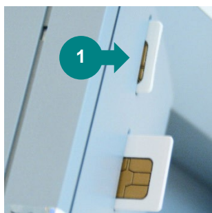
Abbildung 26: Einsetzen der SMC-Karten in die Kontaktiereinheit 3 und 4
