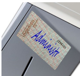
Abbildung 27: Die richtige Positionierung des Slotsiegels
