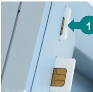
Abbildung 1: Einsetzen der SMC-Karten in die Kontaktiereinheit 3 und 4
