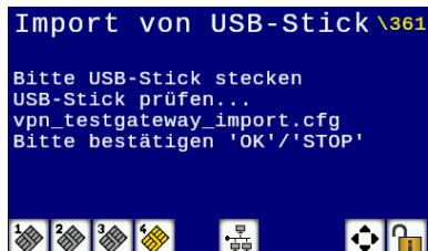
Wählen Sie dazu den Menüpunkt [*Import von USB-Stick \361*] und folgen Sie den Anweisungen bzw. stecken Sie den USB-Stick in die entsprechende Buchse an der Unterseite des Kartenterminals. Der Dateiname wird im Display angezeigt und Sie werden zur Bestätigung mit der ‚OK‘-Taste aufgefordert. Anschließend startet der Import.
