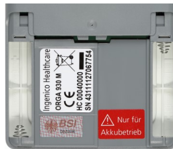
Abbildung 7: Typenschild des ORGA 930 M online mit Seriennummer
